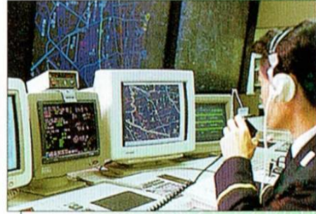
1992年：制御製作所 パトカーにナビゲーション装置を搭載し、現在位置と業務内容を送信することで通信指令センターで地図上に車両の位置をリアルタイムに表示させるパトカー動態管理システムを納入
